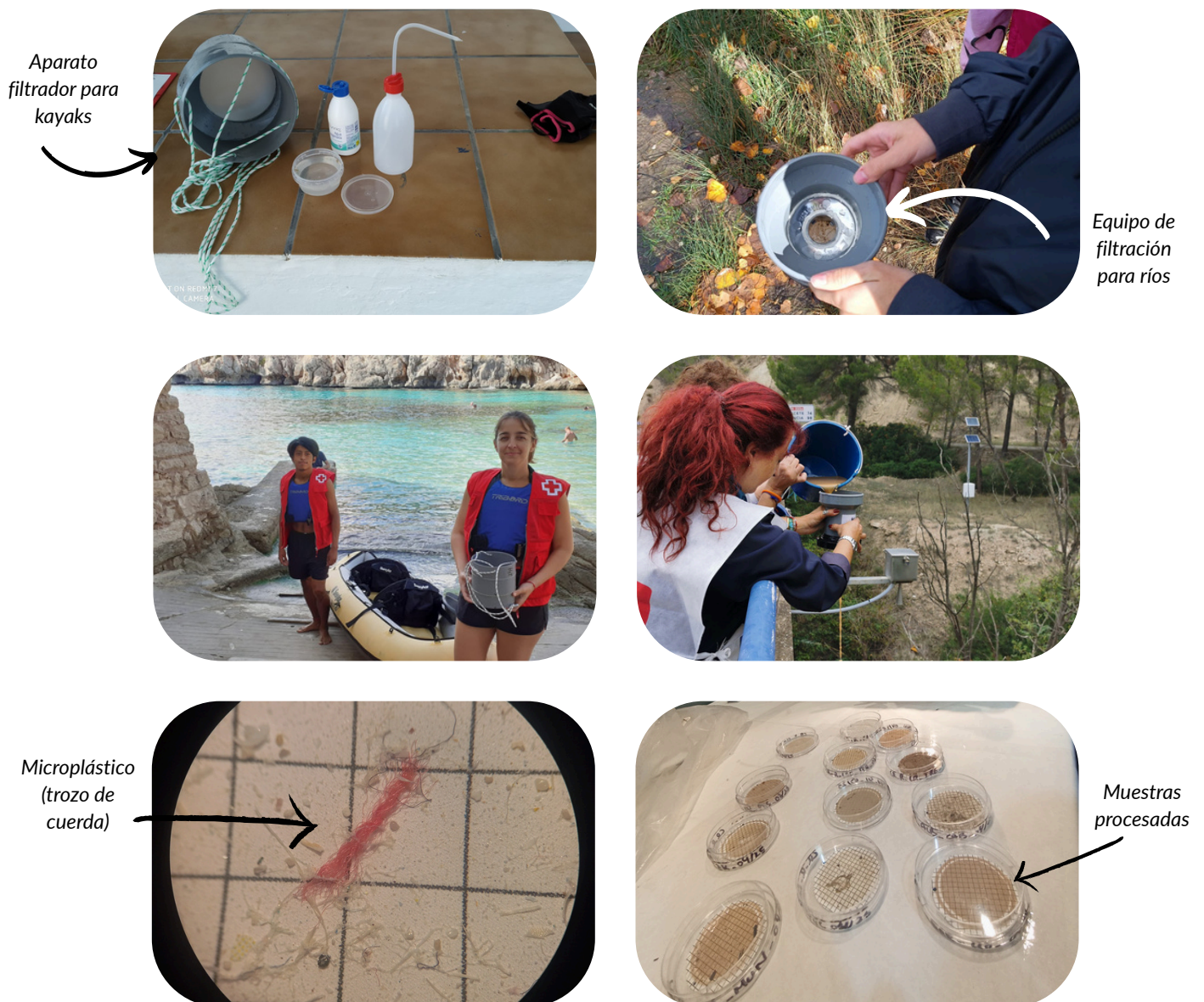
Kits de muestreo para playas y ríos, muestreos y filtros con partículas de microplásticos tras el análisis.
