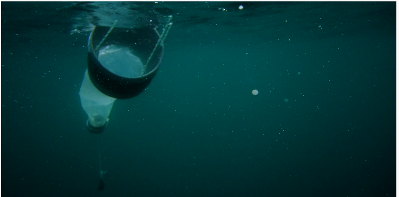
Fig. 3. Red bongo para la toma de muestras con flujómetro adaptado. Fig. 3. Bongo sampling net with adapted flowmeter.
